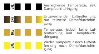
Farbumschlag eines Standard-Indikatorstreifens. Bei Verwendung des Indikatorstreifens für das Prionenprogramm ist die Ausgangsfarbe rosa.
