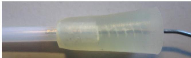
Abbildung 2 Thermoelement im Teflonschlauch.
